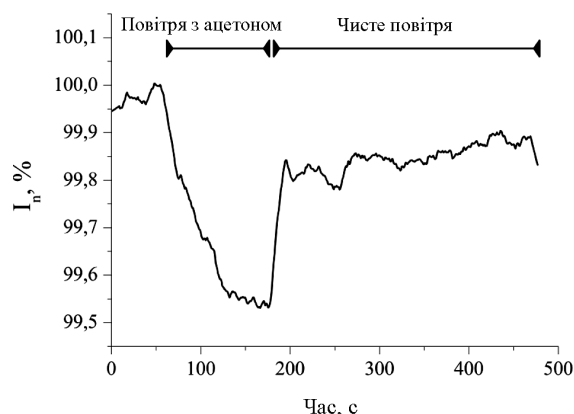
Рис. 4. Кінетика флуоресценції (збудження на довжині хвилі \lambda_{ex} = 335 нм) плівки аеросилу з Соu4: інтервал 60–180 с – прокачування повітряної суміші з концентрацією ацетону 15 ppm, 180–480 с – прокачування повітря без ацетону
