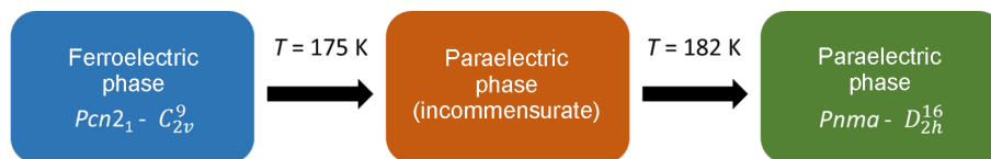
Рис. 1. Схема температурного розміщення фаз та фазових переходів кристала (\text{NH}_4)_2\text{BeF}_4
