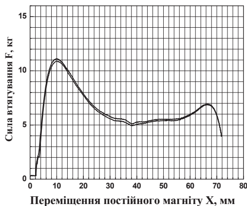
Рис. 6. Силова характеристика магнітної пружини подвоєної довжини: довжина трубчастого магніту 70 мм, зовнішній діаметр 40 мм, внутрішній діаметр 25 мм
