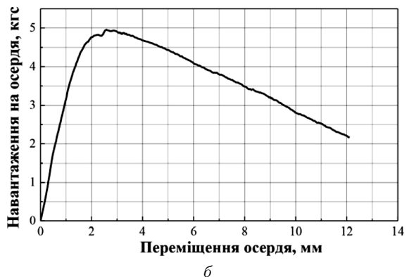
Рис. 3. Силкові характеристики магнітних пружин: базова модель (а) та пружина з магнітопроводом замість зовнішнього постійного магніту (б)
