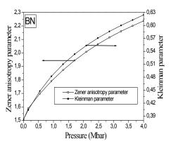
Fig. 4. Zener anisotropy parameter Z and Kleinman parameter  $\xi$  versus the pressure
